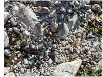
Sédiments composés principalement de graviers avec D_{50} = 56.4 mm
